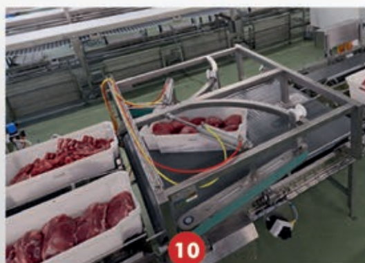
10 WEWNĄTRZAKŁADOWY TRANSPORT POJEMNIKÓW
